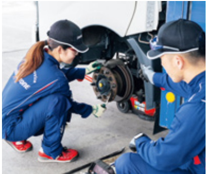
タイヤ取り付け部分の清掃・点検の様子
