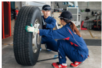
「交換後のタイヤをレバーですくい上げて車に装着する作業。入社したての頃は、空いた時間に壁を使ってよく練習しました」と居森さんと新見さん
