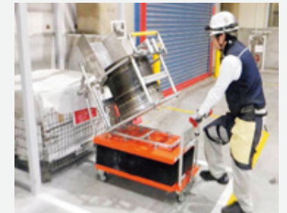
精練工程 薬品投入のからくり改善
