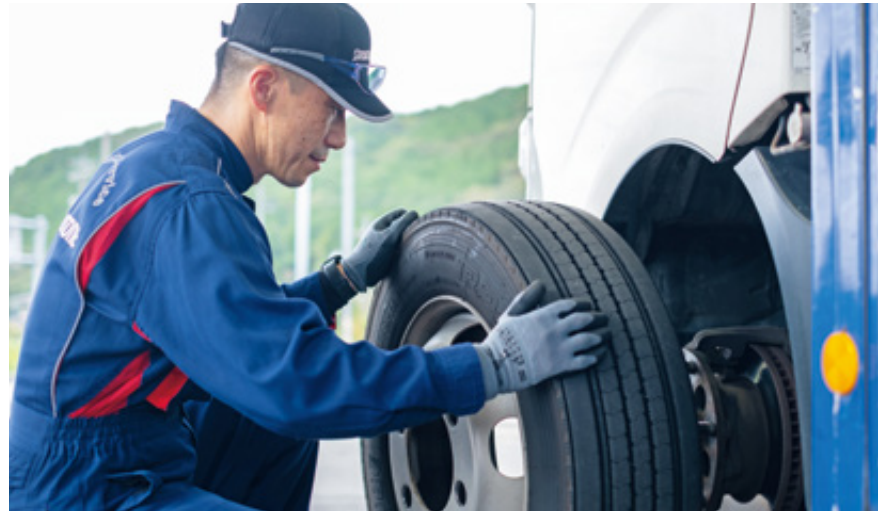
「組み替え作業のコツの第一歩は、ホイールがビード部分と接触するので、それを傷めないようにすること」と新見さん
