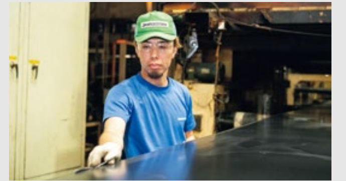
加硫後のピカピカに反射する表面の美しさに注目! 決められたシートの寸法からはみ出た不要な部分をハサミでカット
