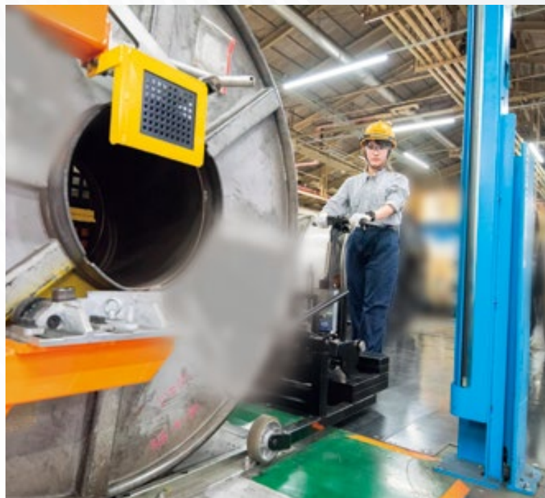
装置は特許を申請中。リールを運搬し、「EXAMATION」へセットできる装置「ラクーロ」。1つ800キロのリールを少ない力で安全に動かすことができる
