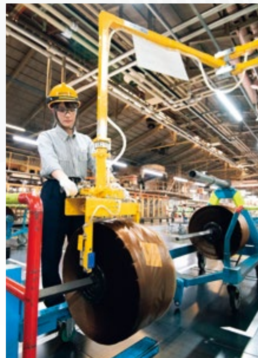
部材を台車から専用リールに掛け替える装置「CCHキャッチャー」。リールは1つ40キロあるため、これまでは腰を痛めるリスクもあったが、装置ではほとんど負担なく作業できるように
