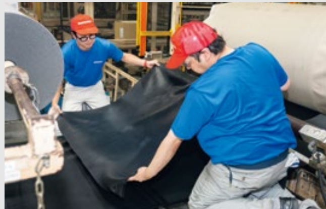
数百メートルに及ぶゴムのシートを広げ、ズレないように慎重に加硫機にセット
