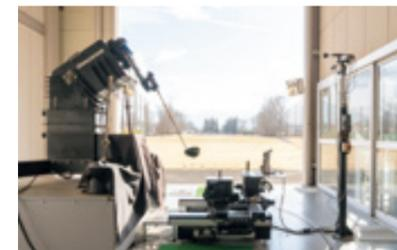
ブリチストンスポーツ テストセンターで使用しているショットロボ。スイングスピードや角度などを自在に設定でき、一定の条件でデータを収集できる
