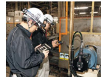
マシンの音の振動幅を確認し、タブレットで見える化。「デジタルによる予兆管理の成功事例を鳥栖工場から広く発信していければ」と酒井さん
