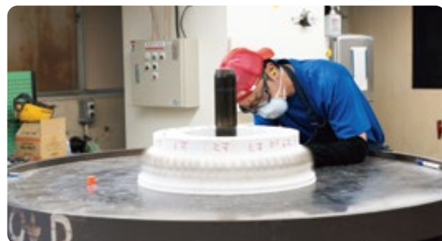
設計通りの寸法を出すために、ステンレス製の板を埋め込む角度や深さは厳密に決められている
