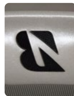
プレミアムタイヤのブランド名やBマーク部分のみ、LUXBLACK ® 技術を用いて加工する。モールドの状態ではBマークが反転している。
