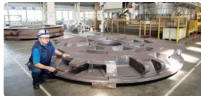
直径は4m以上。サイド部だけでも重量は10tを超える
