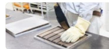
加硫したゴムとスチールコードの接着試験
