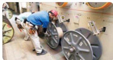
適切なタイミングで瞬時にワイヤーをカットして次の巻取り機へ切り替え
