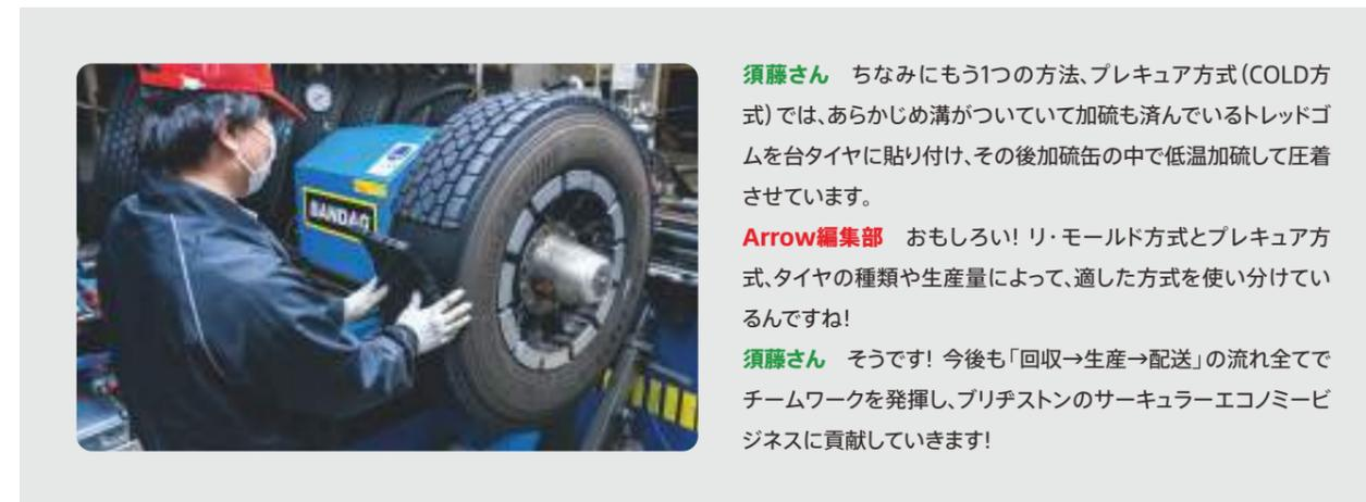
**須藤さん** ちなみにもう1つの方法、プレキュア方式(COLD方式)では、あらかじめ溝がついていて加硫も済んでいるトレッドゴムを台タイヤに貼り付け、その後加硫缶の中で低温加硫して圧着させています。
