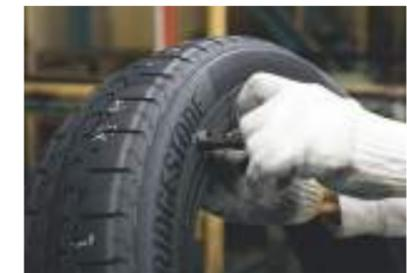
「加硫後のタイヤのスピーー®をカットし、目視と触診でチェック。最後に検査印を押すのですが、きれいに検査印を押すのにも実はコツがいるんです」と保田さん
