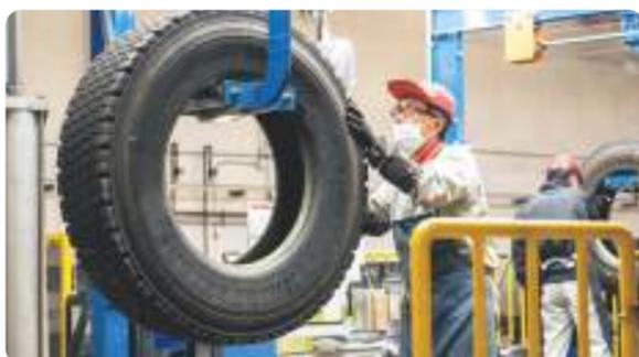
回収したタイヤは検査員とセンサーの2段階で検査。厳しい検査基準のもと、台タイヤとして使えるものを選びます
