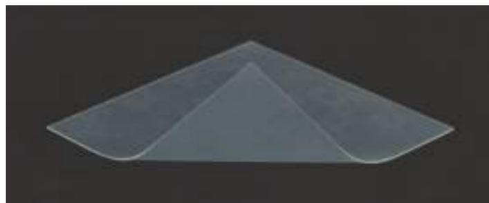
SUSYM：ブリヂストンが開発した、ゴムと樹脂を分子レベルで結びつけた世界初の素材。ゴムのしなやかさと樹脂の強度を併せ持ち、さまざまな分野での活用が期待されています。
