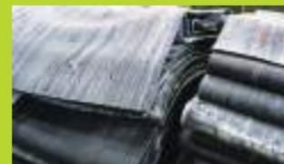
押し出し工程でできた荒生地。さまざまな部材に加工されて用いられます。
