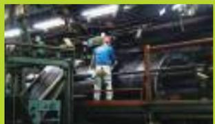
成型工程でゴムシートを巻き付けるところ。ゴムは長くなればなるほど伸び縮みの誤差が大きくなるため、人の手で調整が必要です。
