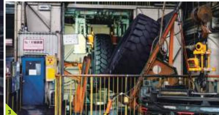
1 明るい照明の下での外観検査。光の当て方や目線の位置にも長年のノウハウが生かされています。2 X線検査は必要な部材が正常に入っているか、規格通りにジョイントされているかをモニターで確認。3 タイヤを持ち上げ、規定の位置に設置するのも大掛かり。1本あたり長いものでは15分ほどかけて丁寧に仕上げ・外観検査を行っています。
