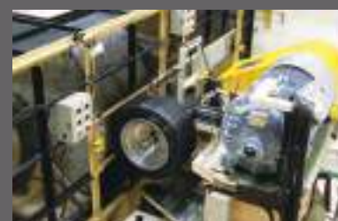
試験機でタイヤを高速回転させ、 タイヤにかかる力の分布を可視化
